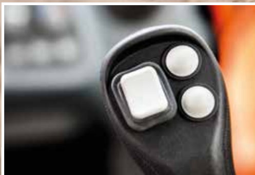
Comutatorul de putere rapidă mărește puterea atunci când este necesar.
