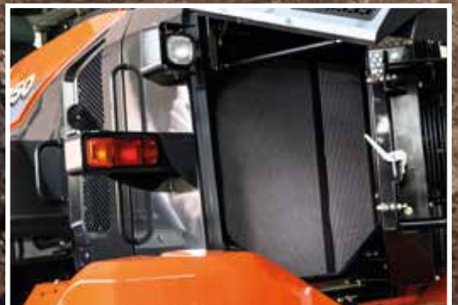
Radiatoarele opționale contra obturării sporesc durabilitatea.
